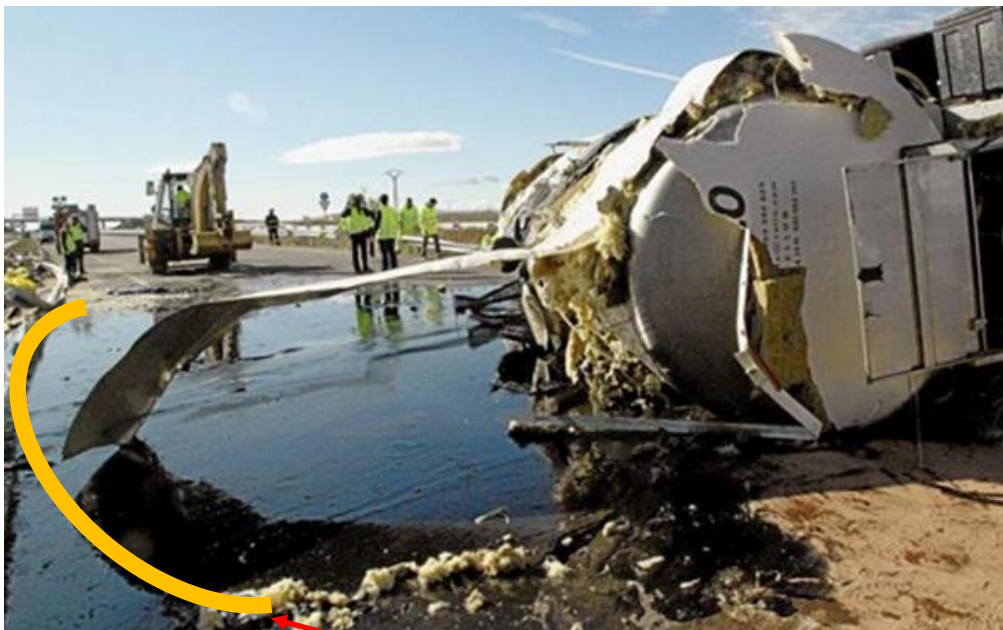
Manguera de 70 como línea de contención - direccionamiento
