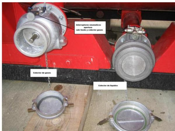
**FUNCIONAMIENTO DE CISTERNAS CON SISTEMA API (Maqueta de Bizkaia)**
